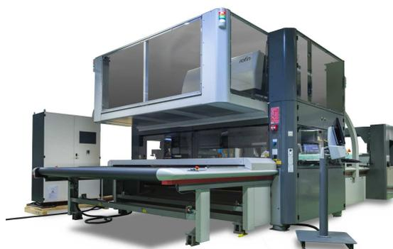
FocusQuantum est une solution complète qui combine un découpeur laser de haute performance pour airbags tissés à plat, un découpeur pour les airbags *one piece woven* (OPW), une suite logicielle dédiée et des services à forte valeur ajoutée. Ces services comprennent notamment la mise en œuvre de la solution, la gestion du changement et l'accompagnement pour garantir l'excellence opérationnelle de la salle de coupe.
