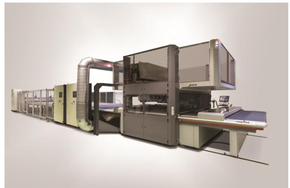
FocusQuantum FT3K, version plus abordable de la solution de découpe laser multipli d'airbags de Lectra, va permettre aux fournisseurs de saisir de nouvelles opportunités en réduisant les coûts de fabrication. Avec une tête de coupe unique et une source laser de 3 kW, ce nouveau modèle met la technologie avancée de FocusQuantum à portée d'un plus grand nombre de fabricants.
